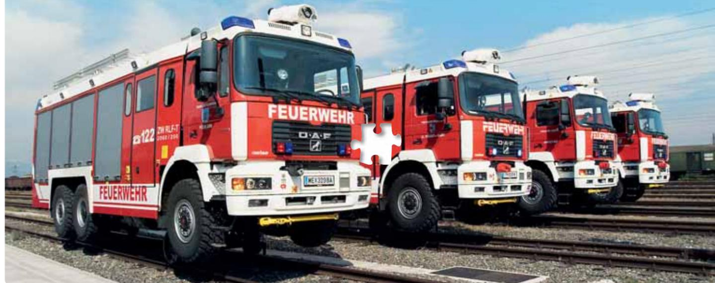
**Ob Unimog, Lkw, Transporter, Bagger oder Sonderfahrzeug – ZWEIWEG International stellt jedes Fahrzeug auf die Schiene. Seit mehr als 50 Jahren werden Fahrzeuge aus dem nordrhein-westfälischen Leichlingen weltweit bei vielen Arbeits- und Sondereinsätzen genutzt – in den U-Bahnen von New York und Caracas, auf den Strecken der japanischen Eisenbahn, im Eurotunnel zwischen Großbritannien und dem europäischen Festland oder auch in den Erzminen von Liberia.**
