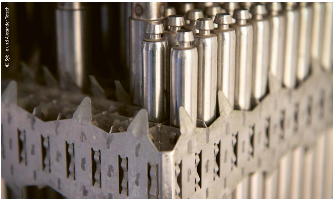
ABBILDUNG 1: Muster eines Brennstabündels eines Reaktors am Kernkraftwerk Greifswald.
